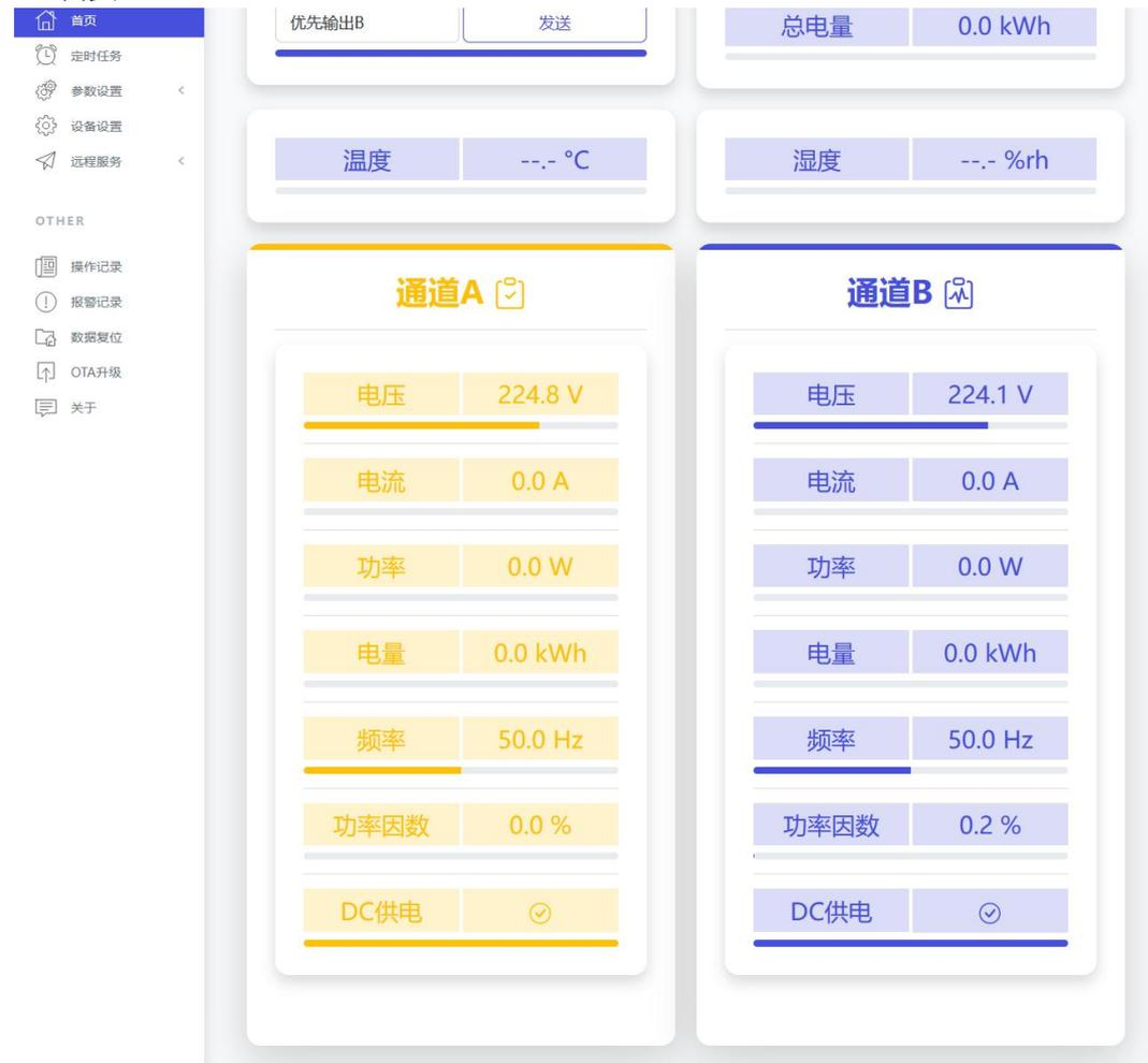
首页可直观查看到总电量、温湿度（如已配传感器），AB路的电压、电流、功率、电量、频率、功率因数等信息）
